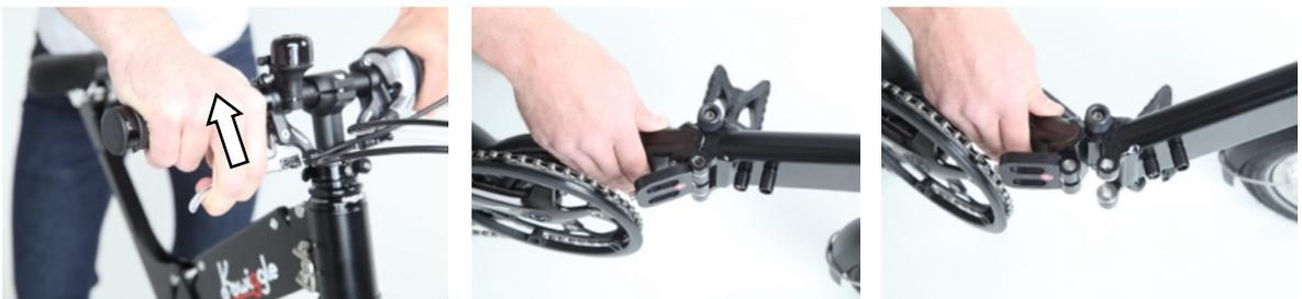
5. Vorderrad nach hinten neben das Hinterrad zwischen die Füße ziehen, Bremshebel gezogen lassen
