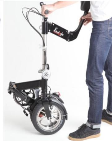
3. Schließe den Hebel am Lenkrohr, indem Du ihn ganz nach unten drehst.
