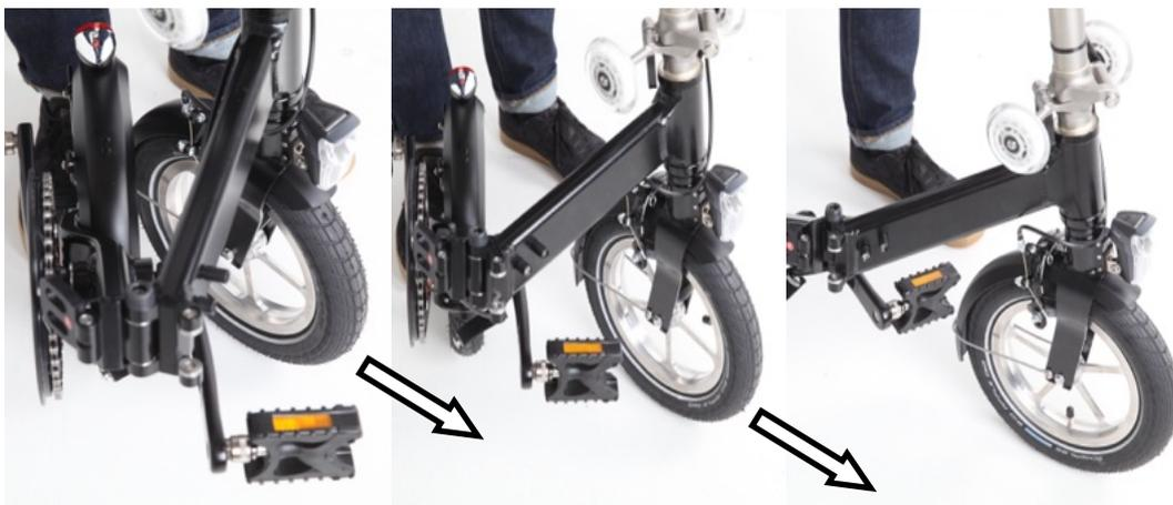
6. SchlieÙe das Rahmengelenk und drehe den Klapphebel, bis er ganz am Rahmen anliegt.
