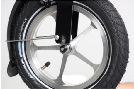
**⚠ Vorsicht! Die Achse muss vollständig oben in der Vorderradgabel sitzen und die Achsschraube muss fest angezogen werden.**
