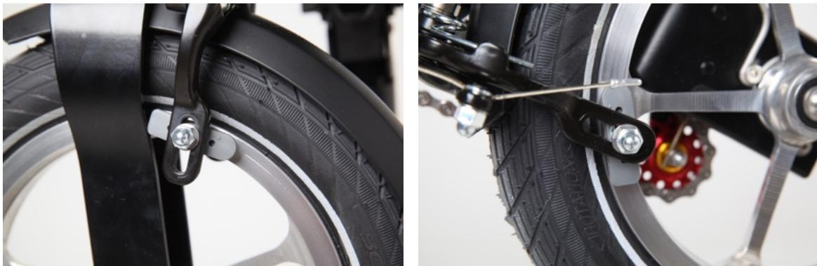
Die Spitze der Bremsbake muss entgegen der Laufrichtung der Felge zeigen.
