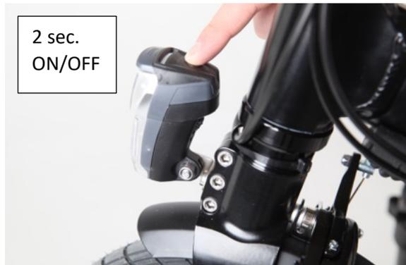
Leuchtet oben auf der Leuchte ein blauer Punkt, strahlt die Leuchte mit voller Leistung. Leuchtet ein roter Punkt, strahlt die Leuchte im Energiespar-Modus. Um den Modus umzuschalten, drücke jeweils einmal kurz oben auf die Leuchte.
