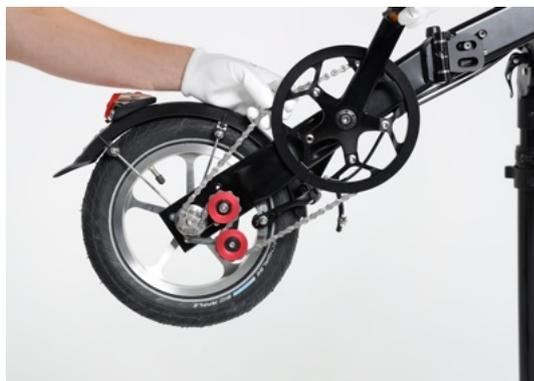
Drehe die Kurbel gegen den Uhrzeigersinn, damit die Kette auf das vordere Kettenrad aufgezogen wird.
