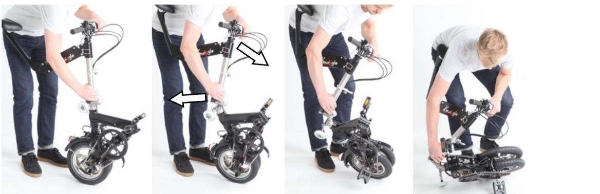
9. Sattelrohr in die rechte Hand nehmen, alle Kabel mit der linken Hand unterhalb des Lenkrohrs zur Seite ziehen, Sattelrohr nach unten führen.
