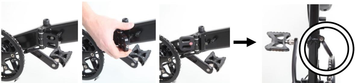
4. Rechten Hinterradbremsehebel ziehen und Rahmen zur Kettenseite hin aufdrücken.
