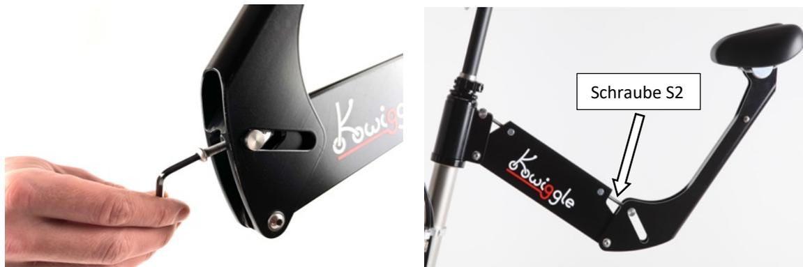
Dieser muss mit Schraube S2 wieder korrigiert werden. Um Schraube S2 zu verstellen, fasst man das Sattelrohr oder den Sattel und bewegt das Sattelrohr etwas nach vorne, um die Schraube zu entlasten.
