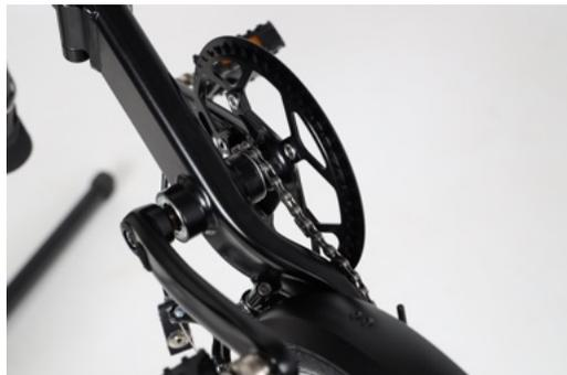
Fädle die Kette mit dem oberen Kettenteil zwischen die beiden Schalträder ein.
