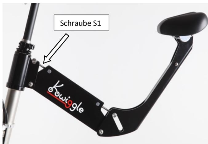
Dann nimmst Du den vorderen Bolzen an der Sattelaufhängung mit Daumen und Zeigefinger in die Hand und ziehst mit der anderen Hand das Sattelrohr nach oben.
