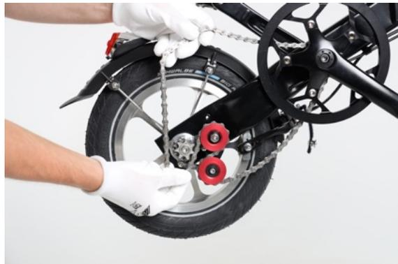
Löse die Kette aus den beiden Schalträdern der Schaltschwinge und entferne die Kette damit von der Schaltschwinge.
