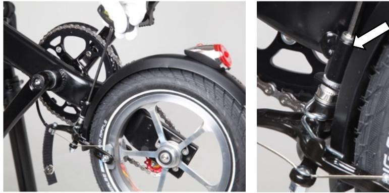
Ziehe die Bremse aus dem Reifen, bis die Bremse frei hängt. Achte darauf, dass keine Scheiben verloren gehen.
