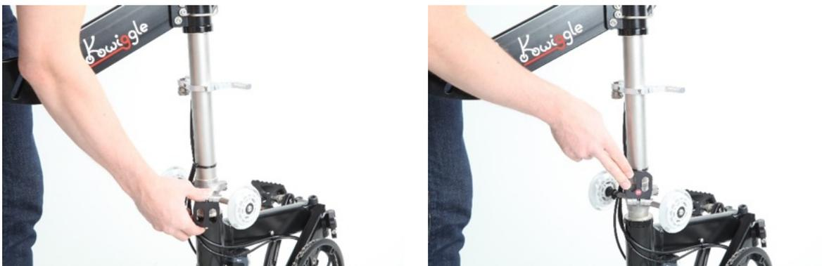
8. Lenkrohr einfalten, dabei das Kwiggle auf dem hinteren Pedal ablegen. Ziehe dabei das Gelenk in der angezeigten Richtung auseinander, indem Du es mit der rechten Hand nach hinten ziehst und mit der linken Hand den Lenker nach vorne drückst.
