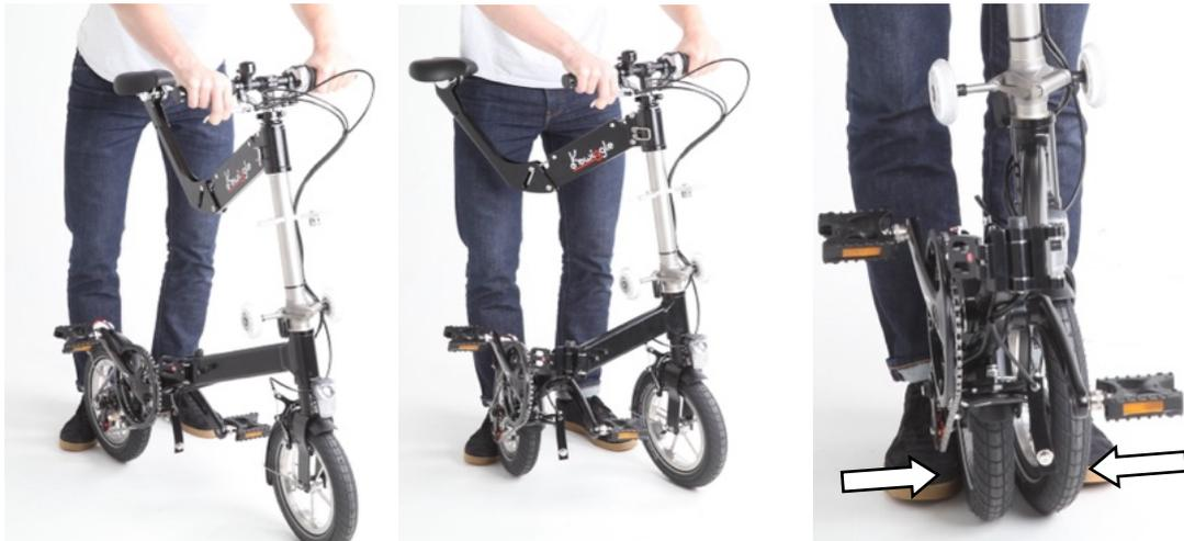
6. Beide Räder müssen eng zusammenstehen. Drücke das rechte Pedal mit dem Fuß kräftig nach unten, bis das linke Pedal mit einem „Klack“ am STOP einrastet.
