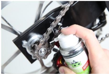
► Drehe anschließend die Kette mehrere Umdrehungen durch. Wiederhole diesen Vorgang solange, bis die Kette nicht mehr quietscht und möglichst leicht läuft. Lass Dein Kwiggle danach einige Minuten stehen, damit der Schmierstoff in die Kette eindringen kann.
