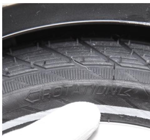
1. Stelle die Felge mit einem Horn in den Reifen. Drücke diese Flanke mit den Daumen komplett über das Horn der Felge. Dieser Vorgang sollte ohne Werkzeug möglich sein. Stecke das Ventil des Schlauchs ins Ventilloch der Felge.
