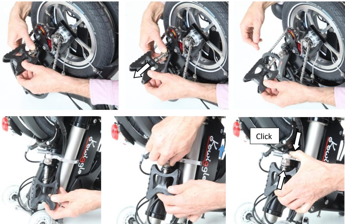
**⚠ Vorsicht!** Achte darauf, dass der Ring an der Pedalaufnahme immer zurückspringt, wenn Du das Pedal eingesteckt hast. Andernfalls besteht die Gefahr, dass das Pedal verloren geht und Du die Kontrolle über Dein Kwiggle verlierst und stürzt.
