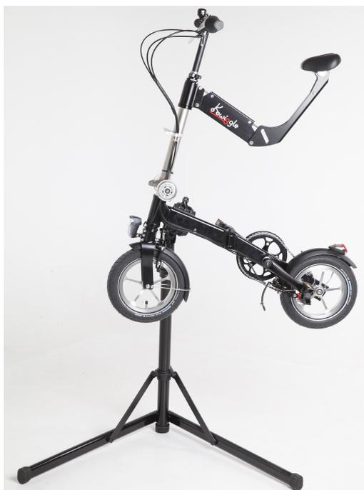
Spanne das Kwiggle im ausgefalteten Zustand mit seinem unteren vorderen Rahmenteil in den Montageständer ein.
