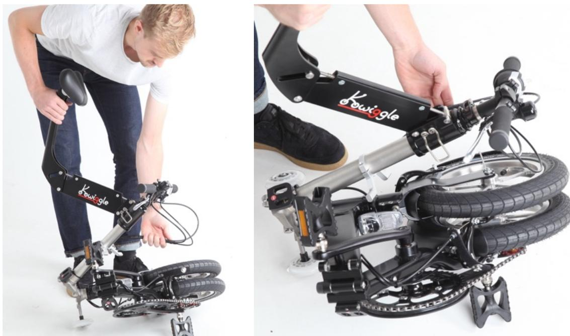
10. Bolzen am Drehgelenk mit Daumen und Zeigefinger nach oben aushaken und aus der Vorrichtung herausgleiten lassen. Das Sattelrohr einklappen und zur Seite drehen.
