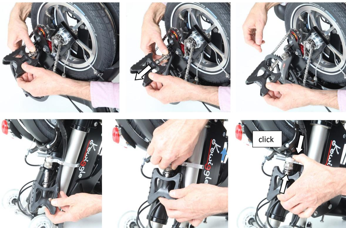
**⚠ Attenzione!** Accertarsi che l'anello del supporto del pedale salti sempre indietro quando si inserisce il pedale. Altrimenti si corre il rischio di perdere il pedale e perdere il controllo del proprio Kwiggle e cadere.
