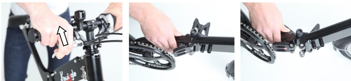
5. Tirare la ruota anteriore all'indietro accanto alla ruota posteriore tra i piedi, lasciare la leva del freno tirata. **IMPORTANTE:** La ruota anteriore non viene ruotata, ma rimane allineata con quella anteriore.
