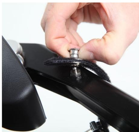
2. Tenere il tubo sella e il manubrio e tirarlo lentamente verso l'alto fino a quando la sella si blocca nel tubo dello sterzo e il Kwiggle si trova sul suo pneumatico.
