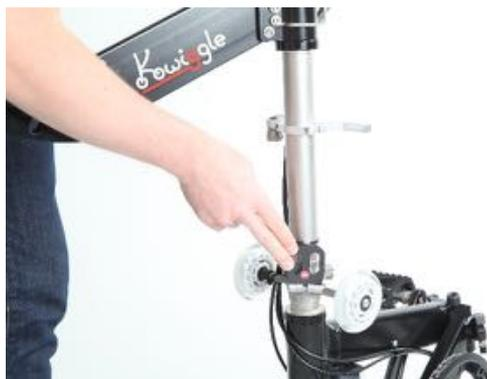
8. Piegare il tubo dello sterzo mentre si posiziona il Kwiggle sul pedale posteriore. Tirare il giunto nella direzione indicata tirandolo all'indietro con la mano destra e spingendo il manubrio in avanti con la mano sinistra.
