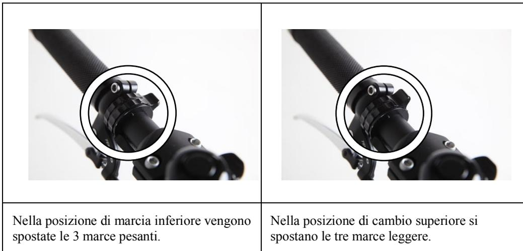
**IMPORTANTE: per passare con successo dalle 3 marce pesanti (posizione della marcia inferiore) alle 3 marce leggere (posizione della marcia superiore), non si deve pedalare durante il processo di cambio.** Altrimenti l'interruttore si muove, ma la nuova posizione di commutazione non si innesta.
