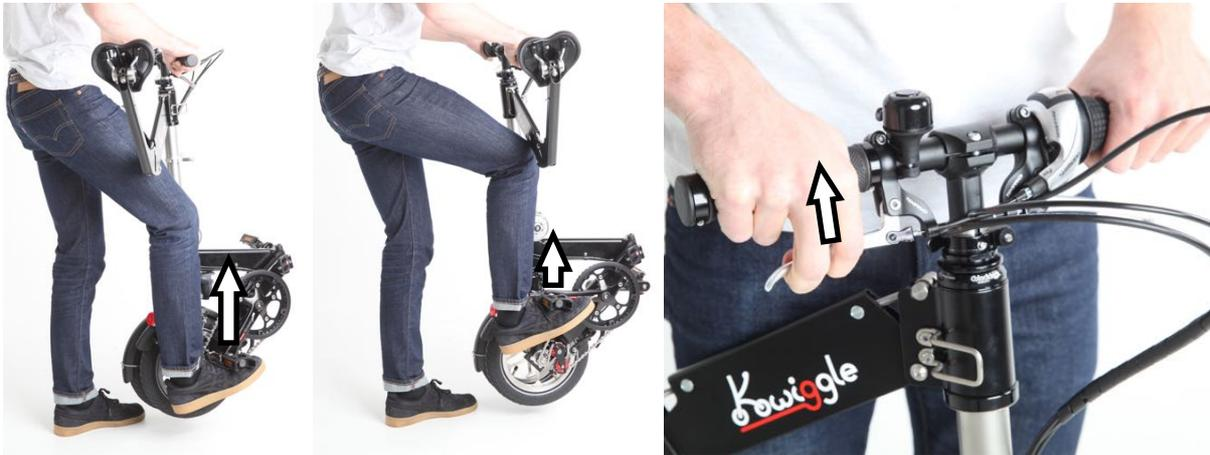
5. Tirare la leva del freno di destra e spostare la ruota anteriore in avanti.
