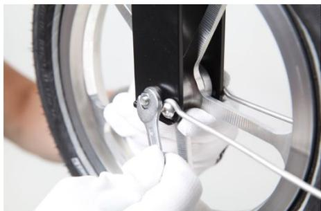
Non ruotare la vite di bloccaggio, altrimenti si danneggia il rivestimento in polvere della forcella. Gira il controdado.
