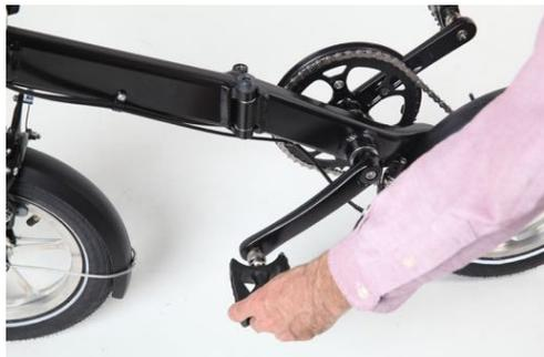
3. Ruotare la leva pieghevole sul telaio fino a quando non è completamente aperto.
