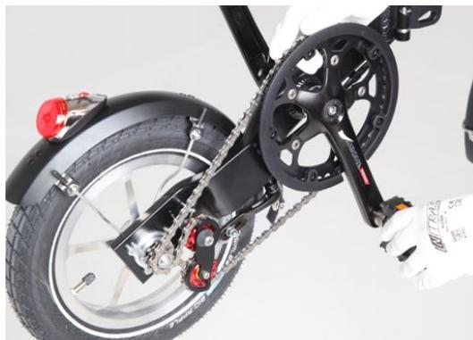
Accertarsi che la gamba inferiore della molla di torsione si innesti nella scanalatura della ruota di controllo inferiore.
