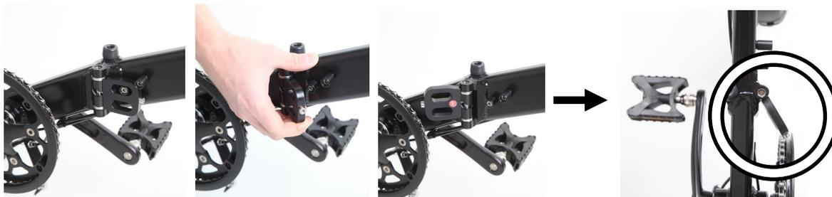
4. Tirare la leva del freno posteriore destro e spingere il telaio verso il lato catena.
