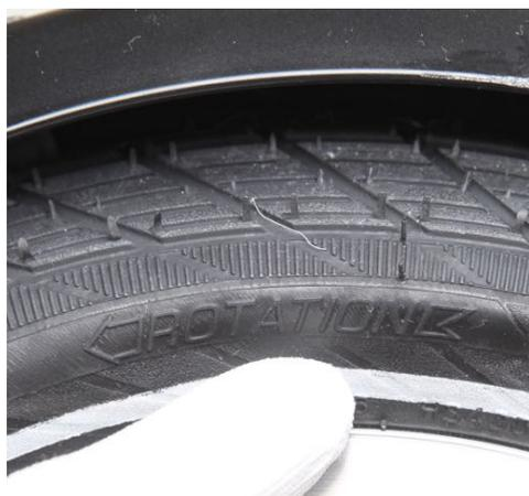
1. Posizionare il cerchio con il clacson nel pneumatico. Premere questo fianco con i pollici completamente sopra il corno del cerchio. Questo processo dovrebbe essere possibile senza strumenti. Inserire la valvola del tubo flessibile nel foro della valvola del cerchio.
