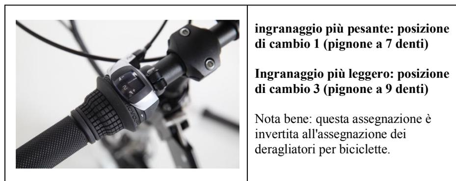
**⚠ Attenzione! Se si gira la manopola per passare ad un'altra marcia, sarà necessario pedalare leggermente per far sì che il cambio proceda senza intoppi.** Se non lo si calpesta, le ruote dentate potrebbero incepparsi. Nel peggiore dei casi il circuito si danneggia e, se necessario, si potrebbe cadere. Se si fa un passo troppo duro, la catena può saltare sopra le ruote dentate e la manovella può scivolare un po'. Anche questo può danneggiare il circuito e provocare una caduta.
