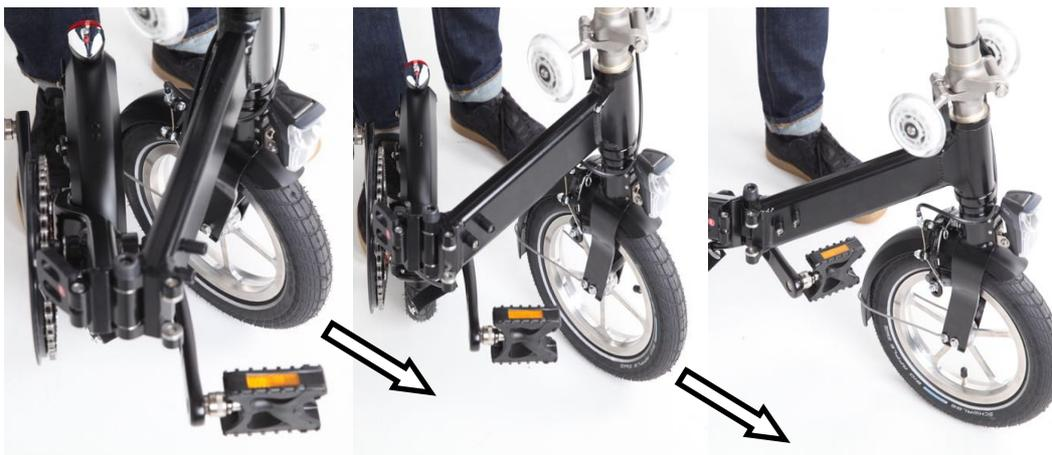
6. Chiudere lo snodo del telaio e ruotare la leva pieghevole fino al completo contatto con il telaio.
