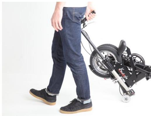
Assicurarsi di rimuovere il pedale destro o di fissarlo al portapedale portapacchi ogni volta che si sposta il Kwiggle in modalità trolley in ambienti ristretti, specialmente in presenza di un intenso traffico pedonale o in negozi con angoli e bordi sporgenti degli scaffali. In caso contrario, c'è il rischio che il pedale destro sporgente si attacchi a qualcosa o ferisca un pedone.
