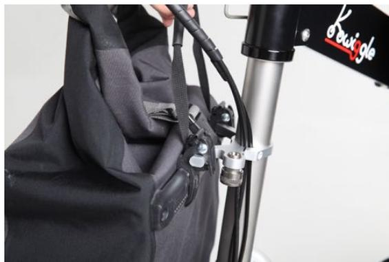
Quando il portapacchi è attaccato al piantone dello sterzo, la borsa si muove in direzione dello sterzo durante lo sterzo. Più pesante è la borsa, più ingombrante è lo sterzo. Inoltre, una borsa pesante può aumentare notevolmente l'angolo di sterzata previsto, di cui si deve sempre tenere conto durante lo sterzo.
