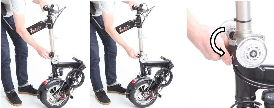
4. Dietro il Kwiggle. Tirare il pedale destro con il collo del piede destro fino a quando le due ruote vengono rilasciate e il telaio si allenta.
