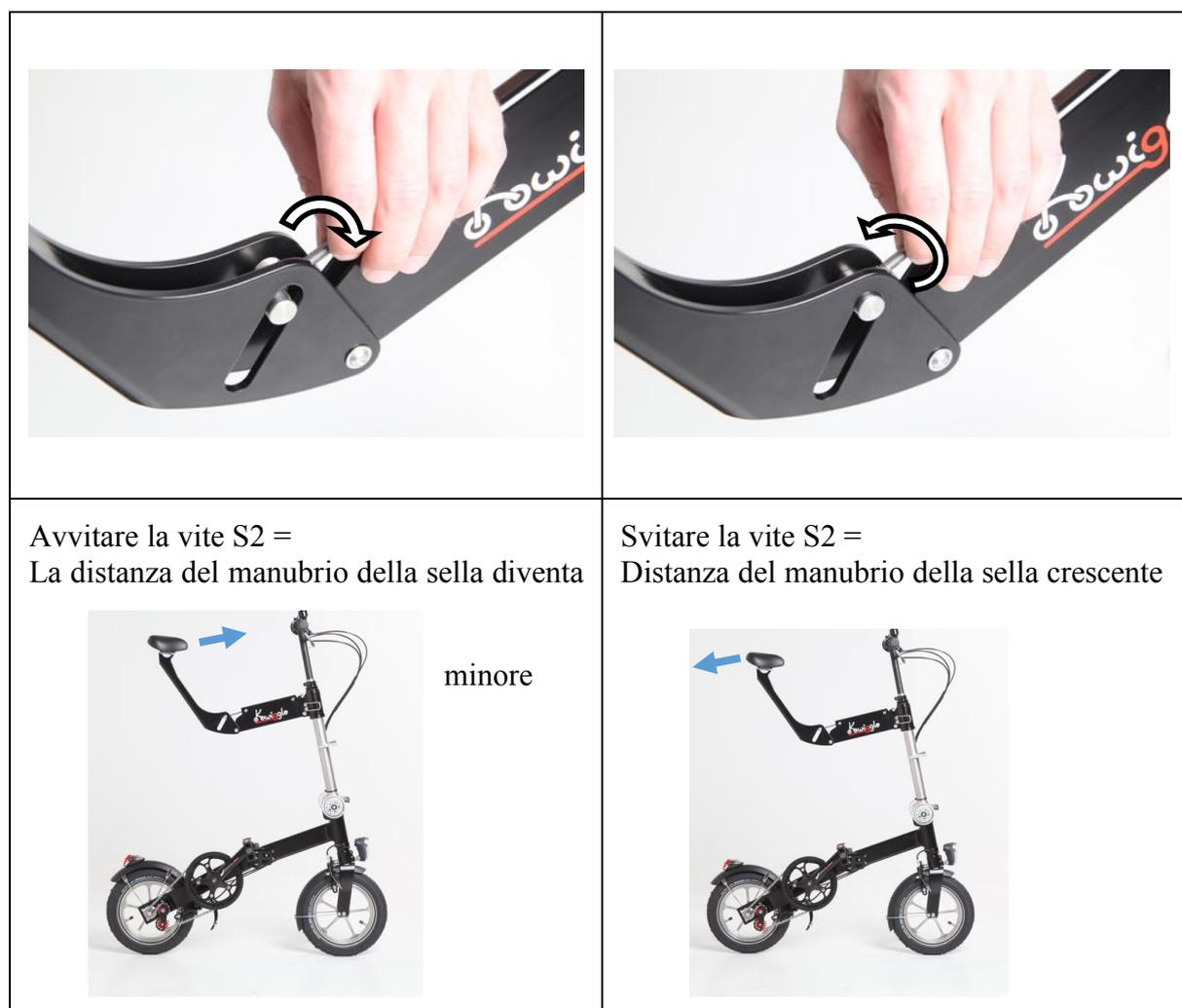
**⚠ Attenzione!** La vite S2 è protetta contro la perdita da un dispositivo di sicurezza all'estremità della vite.
