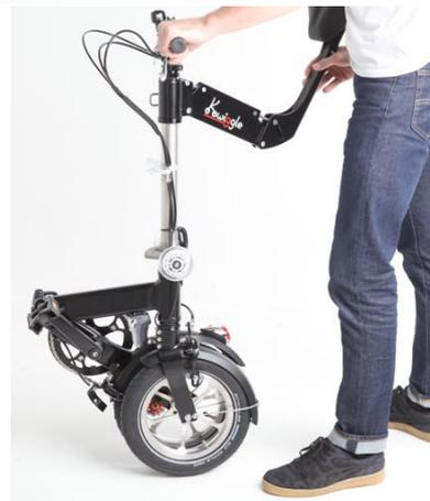
3. Chiudere la leva sul tubo dello sterzo ruotandola completamente verso il basso.
